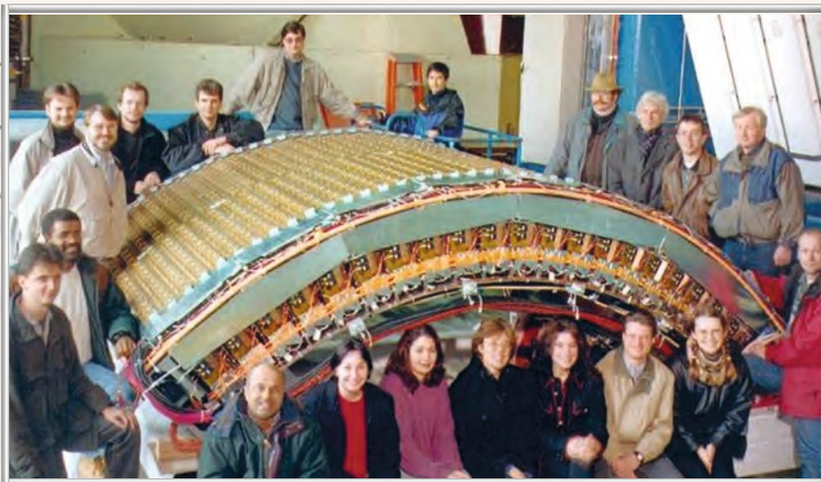
Часть центральной трековой системы детектора PHENIX, созданная в ОФВЭ группой В. М. Самсонова для изучения ядро-ядерных соударений на коллайдере RHIC
